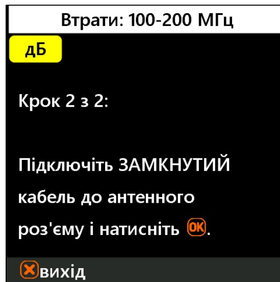
Малюнок 8 – Вимірювання втрат в кабелі. Крок 2
