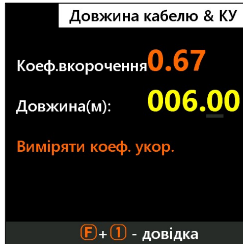
Малюнок 13 – Довжина кабелю та коефіцієнта укорочення
