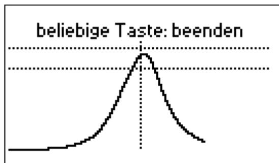
Der obere Teil der Kurve sollte in der Mitte des Bildschirms zwischen zwei horizontalen Linien dargestellt werden. Eine kleine horizontale Verschiebung der Kurve ist erlaubt.
