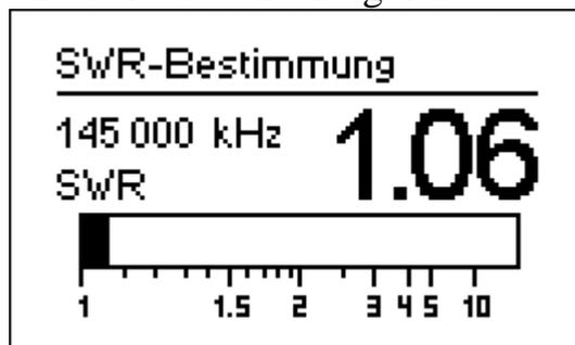
Stellen Sie die gewünschte Frequenz ein (Taste **2**) oder wechseln Sie diese mit der linken bzw. rechten Pfeiltaste.
