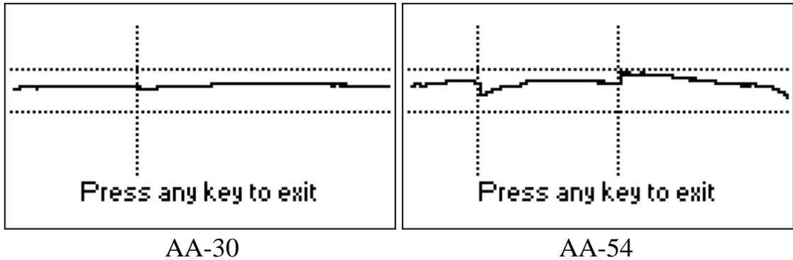
Der Spannungskurve sollte zwischen den beiden horizontalen gestrichelten Linien verlaufen. Die senkrechten Linien zeigen die Grenzen der Subbänder des jeweiligen Analyzers.
