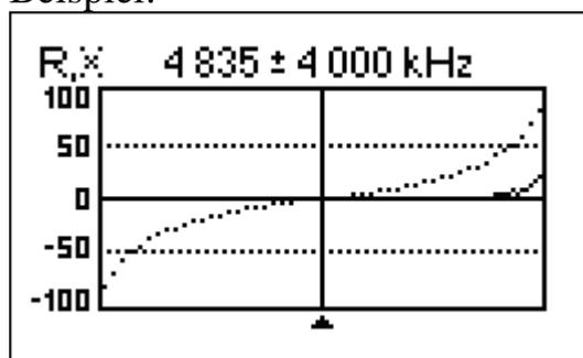
Die Viertelwellen- Resonanzfrequenz eines offenen Stücks RG-58-Kabels beträgt 4835 kHz
