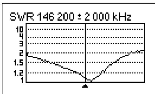
Das obige Bild zeigt den Graph des Stehwellenverhältnisses einer vertikalen VHF-Antenne, die über 40 m Kabel angeschlossen ist. Die Arbeitsfrequenz ist 146,2 MHz. Das SWR auf dieser Frequenz ist rund 1,1, was akzeptabel ist.
