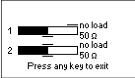
Sollten die Balken überhaupt nicht gefüllt sein, liegt entweder ein Defekt an der Endstufe oder am HF-Detektor vor.
