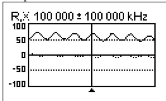
3. Wechseln Sie den Anzeigebereich so lange und führen Sie weitere Scans durch, bis Sie eine Frequenz finden, an der R (Volllinie) sein Maximum erreicht und eine weitere Frequenz mit seinem Minimum. An diesen Punkten schneidet X (gepunktete Linie) die Nulllinie.
