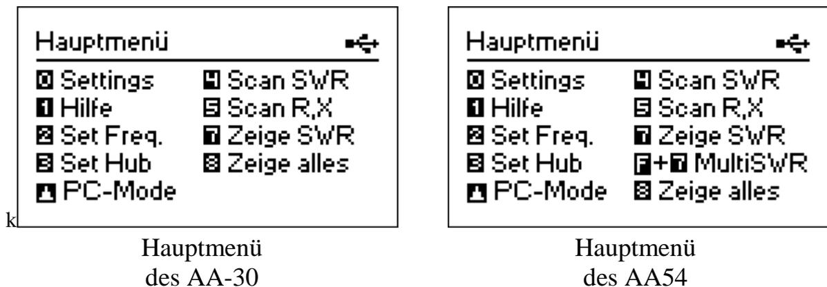
Das *Hauptmenü* enthält eine kurze Liste der verfügbaren Befehle. Durch Drücken der Tasten auf der Tastatur, können Sie die entsprechenden Messmodi aufrufen.
